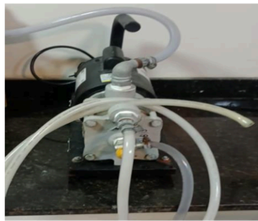
Figura 3: Bomba Aspiradora; Conectada Junto à Cânula Aspiradora com Finalidade de Aspirar as Cavidades Torácica e Abdominal, Removendo Fluidos e Gases Evitando Extravasamento de Líquidos Cadavéricos. Acervo Próprio, (2026).
