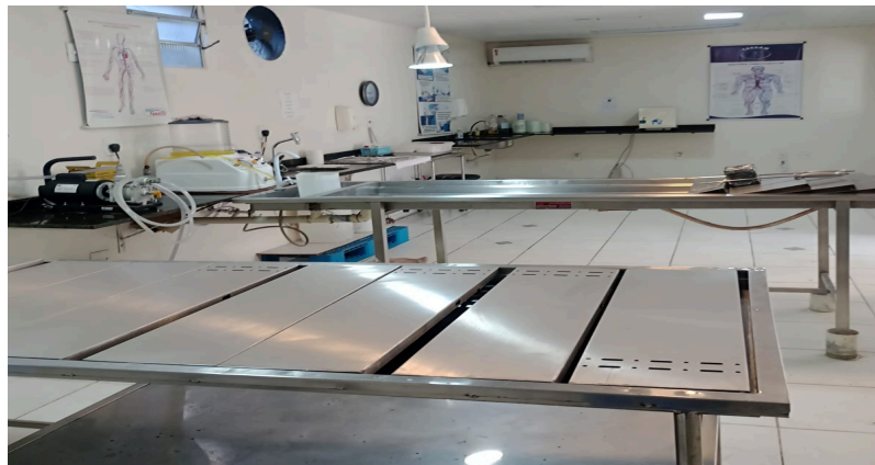
Figura 2. Mesas em Aço Inox com Supostes Removíveis e Ligeiramentes inclináveis; Acervo Próprio, (2026).
