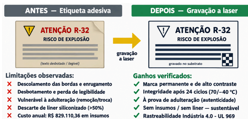
Figura 2. Comparação entre etiqueta adesiva e identificação por gravação a laser.
