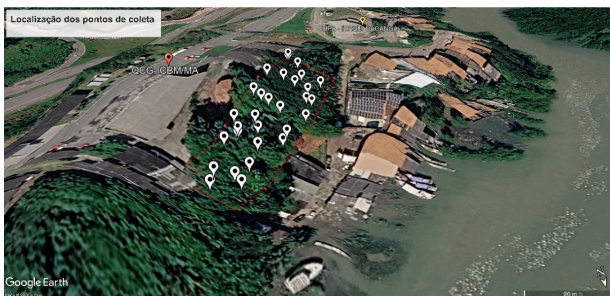
Figura 4. Localização dos 30 pontos de medição do PenetroLOG
