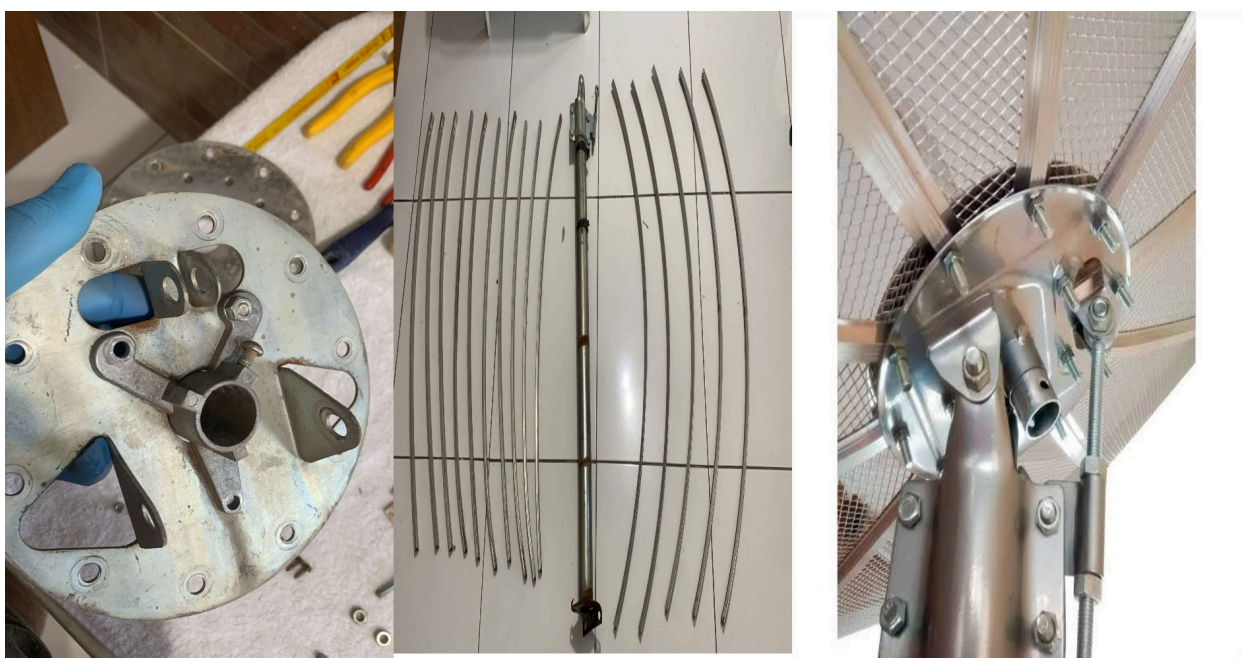
Figura 16. Fixação do concentrador parabólico.
