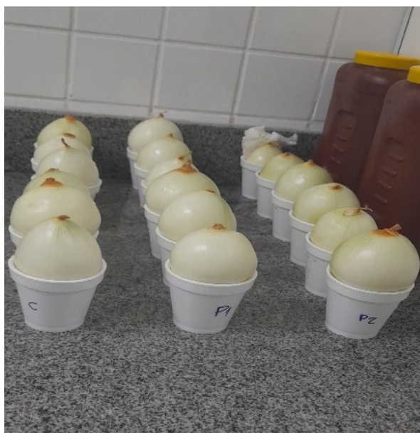
Figura 2. Ensaio de fitotoxicidade com Allium cepa L.
