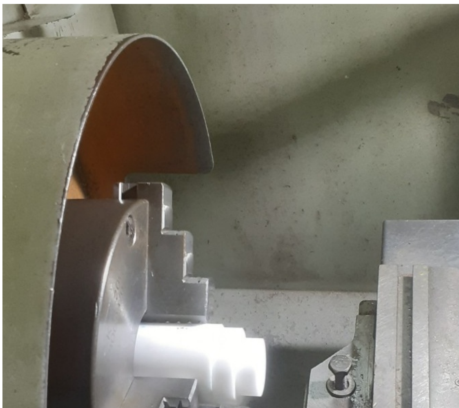
Figura 1. Confeção da geometria inicial da engrenagem no torno mecânico.
