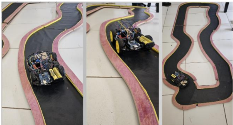
Figura 5. Robô móvel desenvolvido com Arduino para o estudo de conceitos de cinemática em pista experimental.
