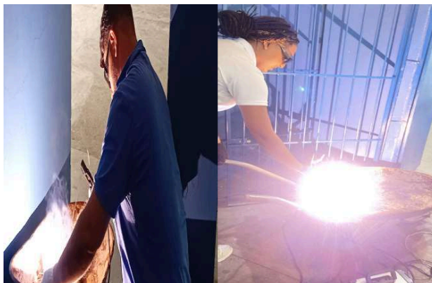
Figura 26 - Solda da Base para assentamento do motor.
