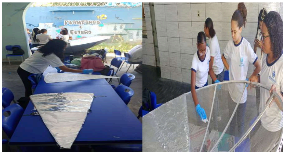
Figura 31 - Montagem das Células do Concentrador Parabólico .
