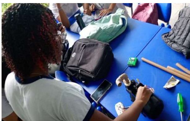
Figura 22 - instalação de imas de neudimio no motor bomba ½ hp - tensao 127v
