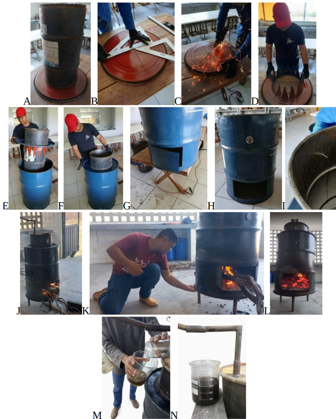
Figura 3 – Ilustração dos tambores metálicos utilizados para compor as câmaras de combustão (200L) e carbonização (80L) do reator de biomassa para produção de biochar e EP
