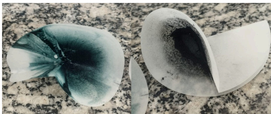
Figura 7: Filtros contendo o catalisador recuperado após a filtração
