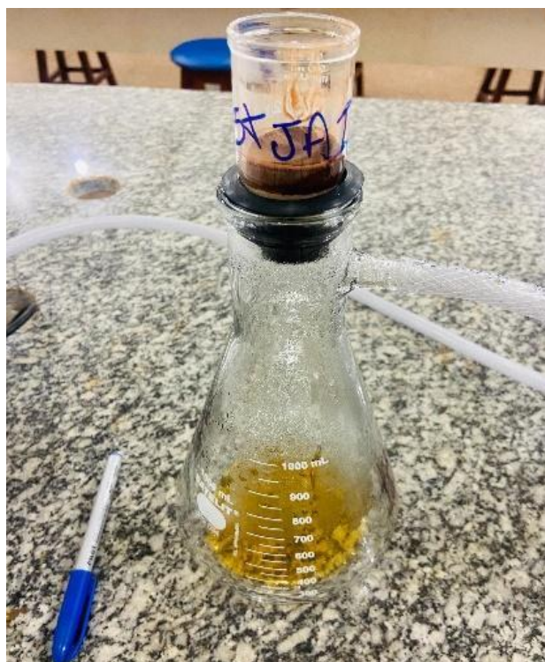
Figura 7: Bomba de vácuo para filtragem do material precipitado com formaldeído.
