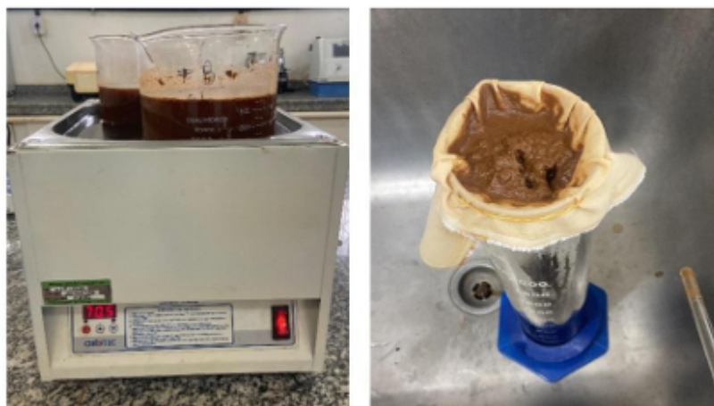
Figura 4: A = Processo de determinação de taninos condensáveis das amostras de cascas coletadas.; B = Filtragem do extrato utilizando-se tecido do tipo flanela.
