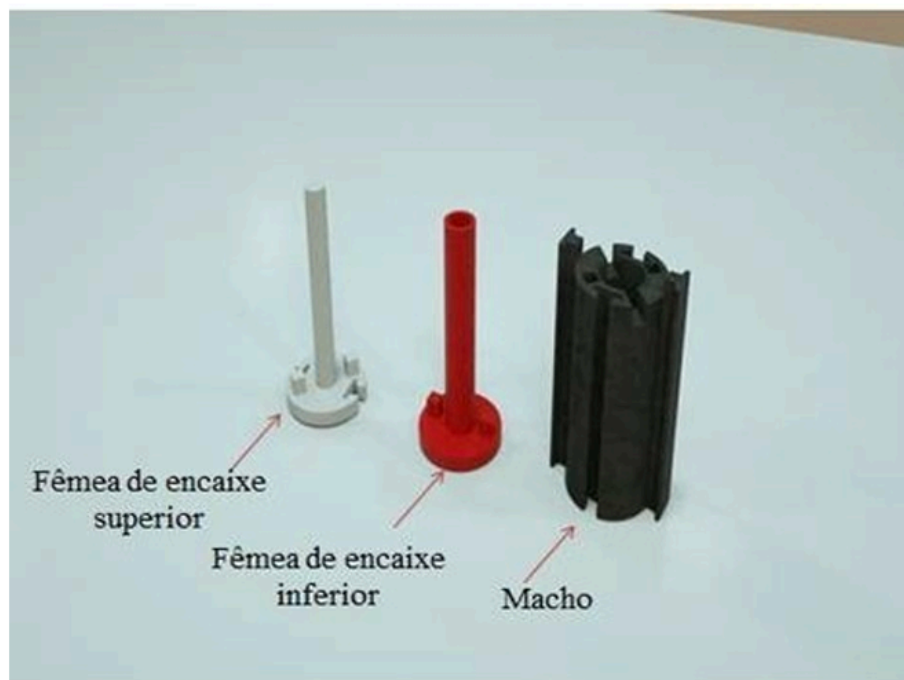
Figura 5: Involucro da célula eletrolítica em forma final.
