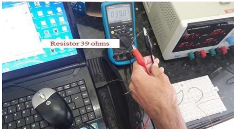
Figura 9: Multitest ET 2232 com o resistor de 39 \Omega .
