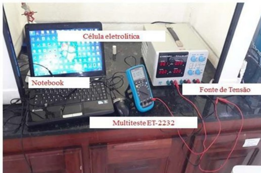
Figura 7: Circuito montado para aferição da tensão de circuito aberto.
