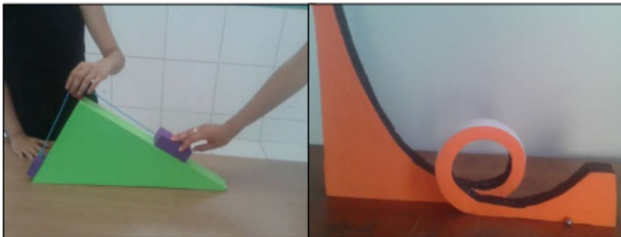
Figura 1. Modelos experimentais: plano inclinado com polia, à esquerda e looping à direita, ambos construídos com isopor, EVA e madeira.
