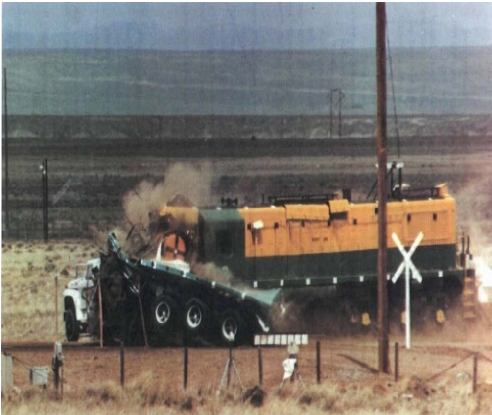
Figura 2: Os recipientes de transporte de combustível nuclear irradiado foram submetidos a uma série de testes de impacto nos Laboratórios Sandia, nos EUA. Neste teste em escala real, uma locomotiva ferroviária, acelerada a 81,5 milhas por hora por um trenó movido a foguete, colidiu com um veículo transportador carregado com um recipiente de combustível nuclear (objeto vermelho).
