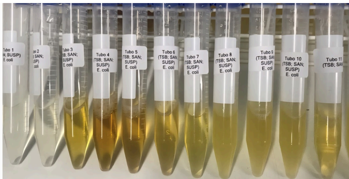
Figura 8 - Diluições seriadas do hipoclorito submetidas à bactérias E. coli , P. aeruginosa e S. au com redução de turvação gradual.
