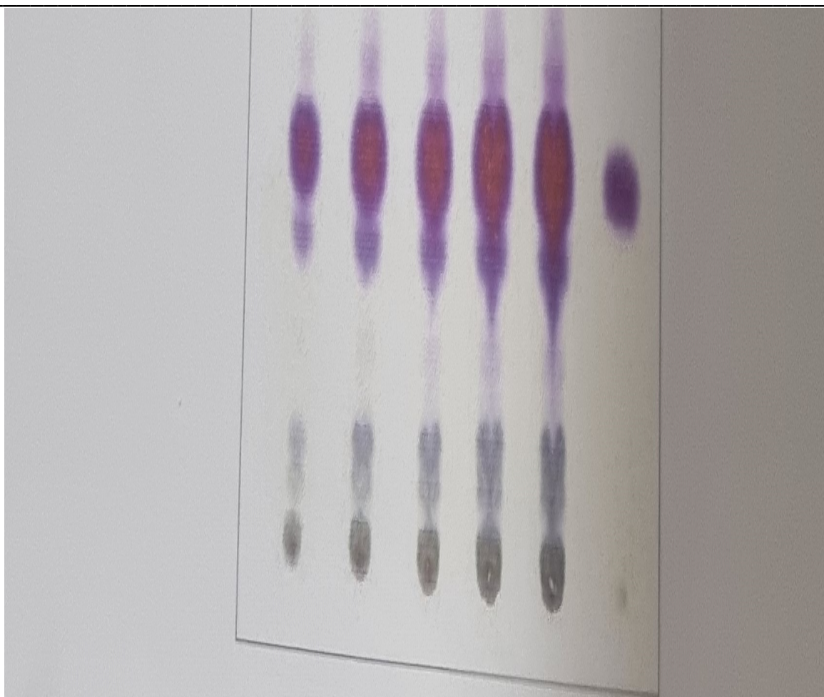
Figura 41. Synadenium carinatum B. Cromatograma do latex e padrão, revelado com reagente ácido sulfovanílico. 1= 1 \mu l de látex; 2 = 2 \mu l de látex; 3 = 3 \mu l de látex; 4 = 4 \mu l de látex; 5 = 5 \mu l de látex e 6- Padrão Lupeol
